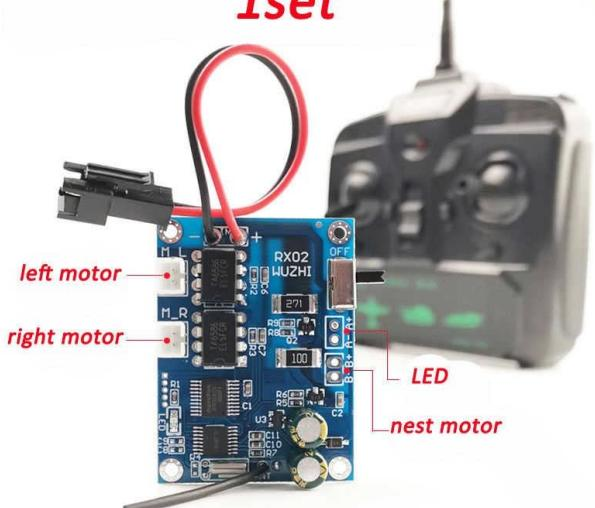
TX + RX 4ch 900Mhz più batteria, 2 motori direttamente pilotati
